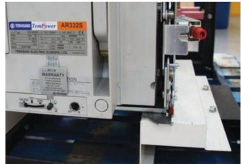
Os suportes de montagem são projetados e adaptados com base em medições realizadas no local para garantir um encaixe mecânico perfeito. Sempre que possível, as nossas medições têm em conta as localizações e posições originais de montagem no quadro elétrico, evitando assim cortes e perfurações no local.
