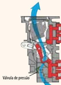
Eficiente Circulação de ar por via de uma válvula de pressão
